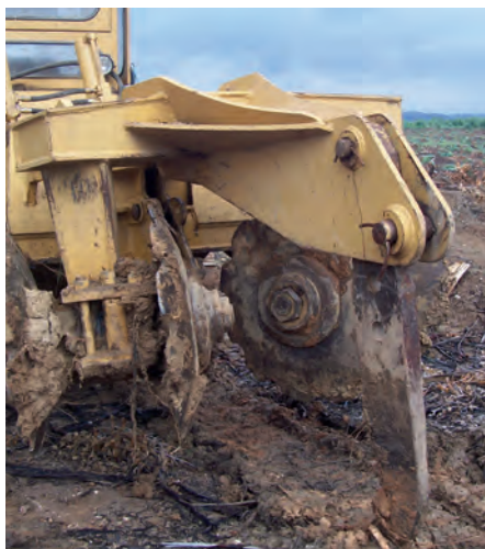
Mobilização com excesso de água no solo (a não realizar)
